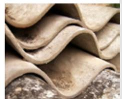
Asbesthaltige Eternitplatten dürfen seit 1993 nicht mehr genutzt werden, eine Entsorgung mit Bauschutt ist verboten
